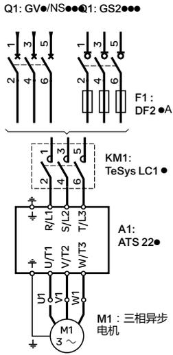
采用断路器或负荷开关保护的电机起动器
