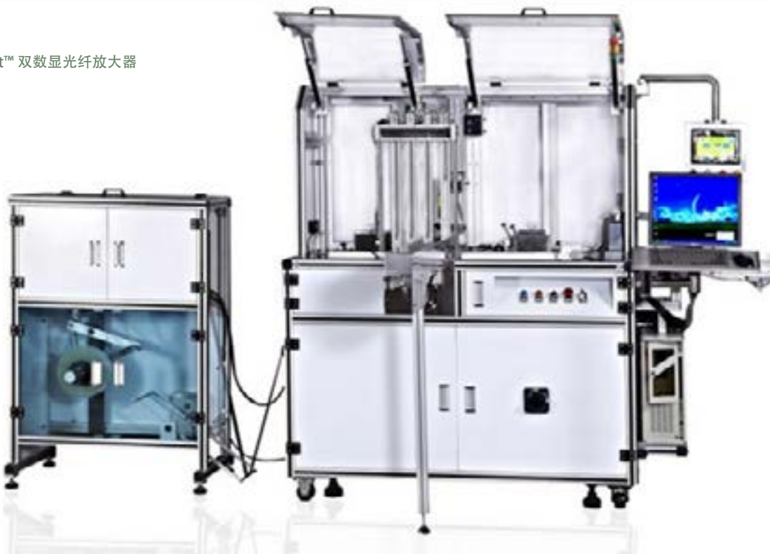
PresencePLUS® Pro 视觉传感器 对IC芯片的缺陷等进行检测
