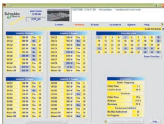
智能负荷卸载管理
